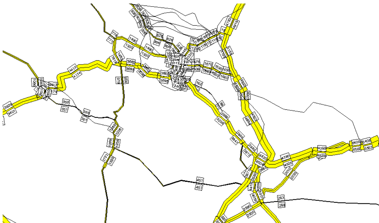
Kartogram predikovaných intenzit automobilové dopravy celkem za 24 h dle makroskopického dopravního modelu silniční sítě
