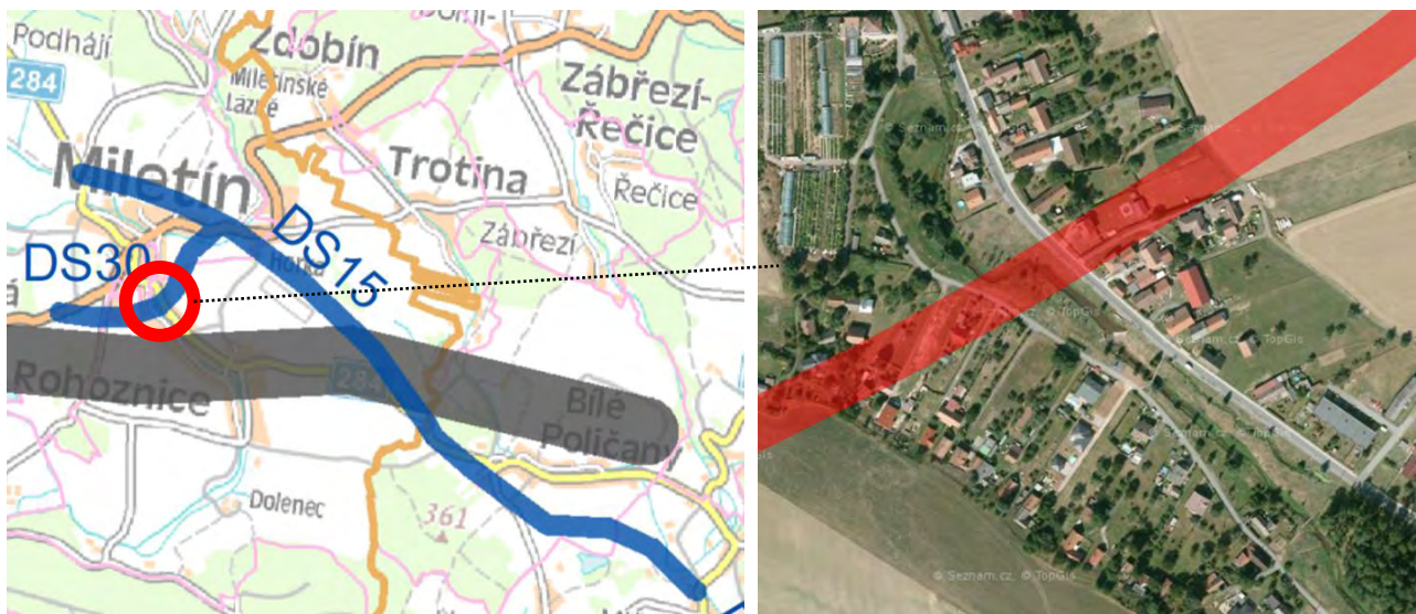
Obchvat Miletína dle planých ZÚR Královéhradeckého kraje – výřez výkresy ploch a koridorů nadmístního významu + detail střetu navrhované trasy přeložky silnice II/300 se stabilizovanou obytnou zástavbou obce Rohoznice (na podkladě letecké mapy mapy.cz)
