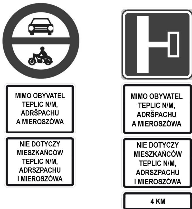
Obr. Návrh zákazové značky B11 s dodatkovou tabulkou E13, k umístění na státní hranici CZ/PL Zdoňov/Łaczna (vlevo) a informativní značka o zákazu vjezdu k umístění na příjezdových silnicích k ke státní hranici (vpravo) [Zdroj: vlastní kresba]
