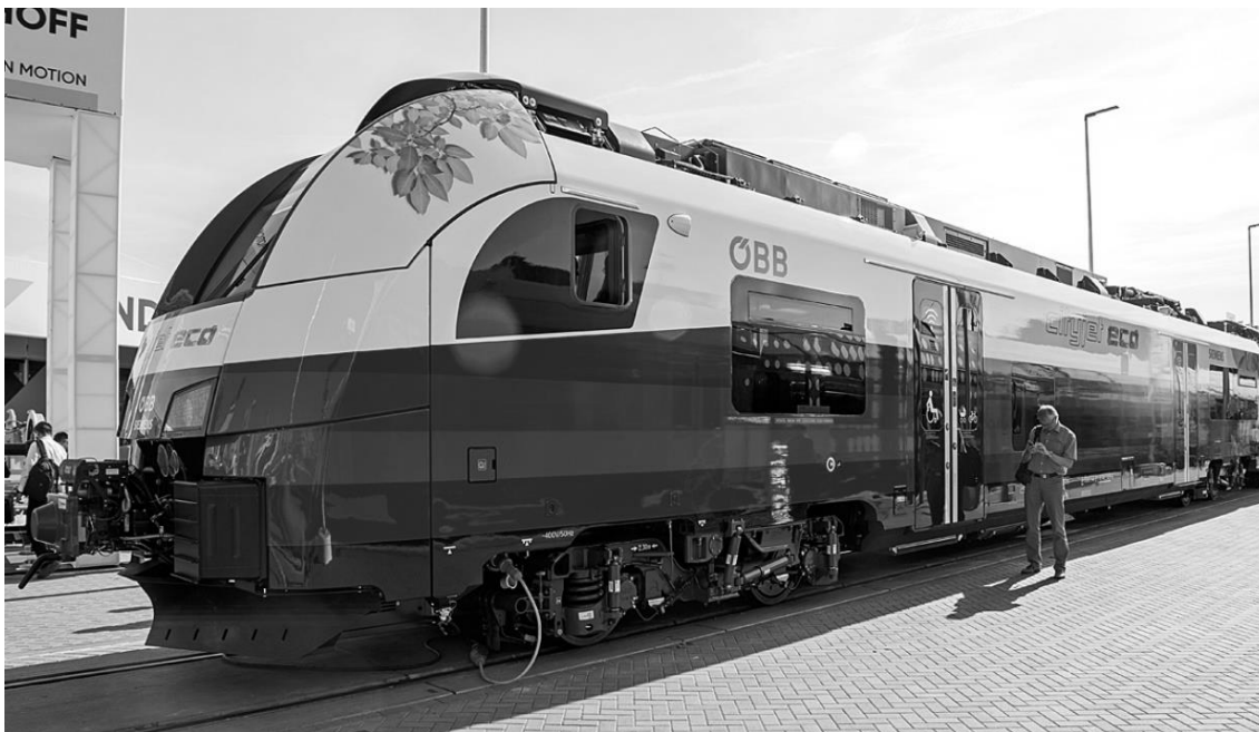
Obr.: Elektrická jednotka na akumulární baterie, vyvíjená společností Siemens pro Rakouské státní dráhy (ÖBB). [Zdroj: hellertal.startbilder.de]
