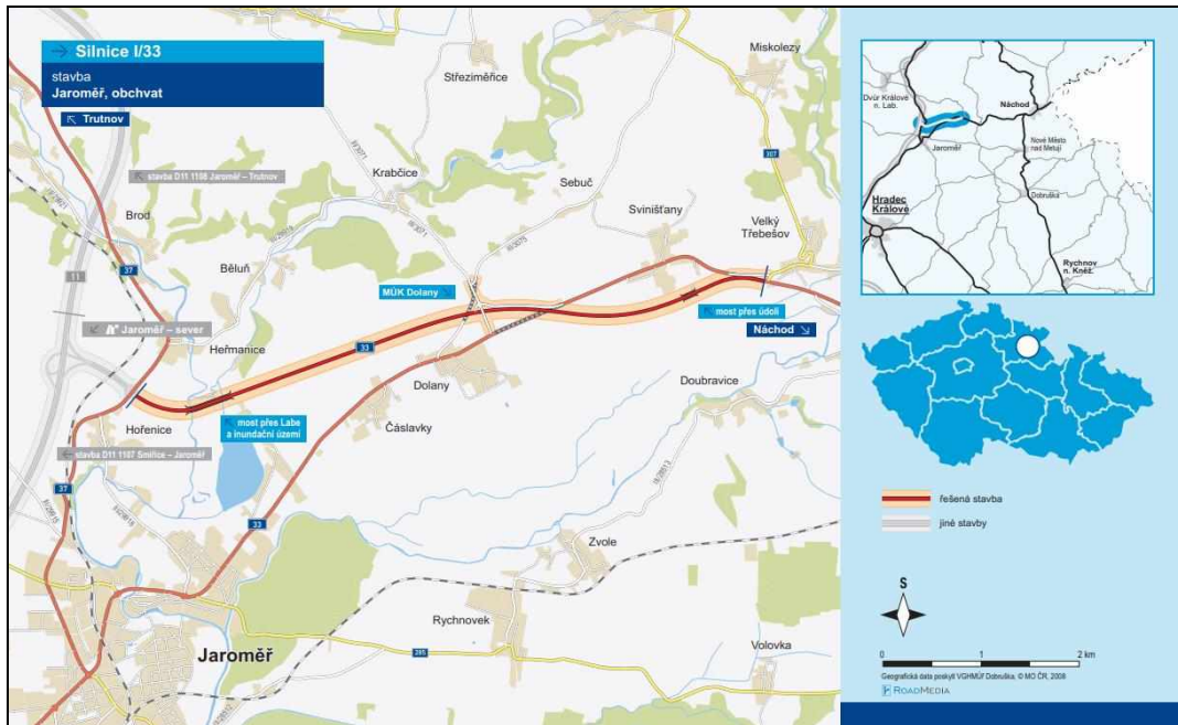
Obr. č. 07 – předmětná stavba a stávající pozemní komunikace v lokalitě, vč. stávajícího vedení silnice I/33 intravilánem obcí; převzato z https://mapapp.rsd.cz/Upload/Stavby/248/infoletak_s33-jaromer-obchvat.pdf?t=2021-12-16%2010:51:10.754
